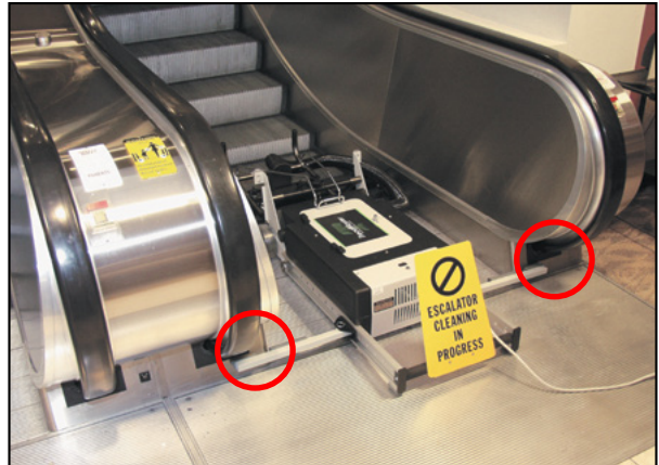
Figure 5. S'assurer que les bras de retenue reposent fermement en place contre les balustrades
