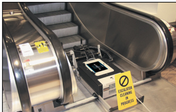
Figure 8. TreadMaster illustré dans la position préférée, en bas de l'escalier mécanique
