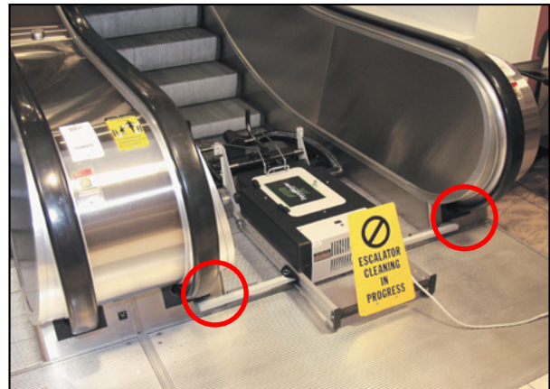
Figure 11. S'assurer que les bras de retenue reposent fermement en place contre les balustrades
